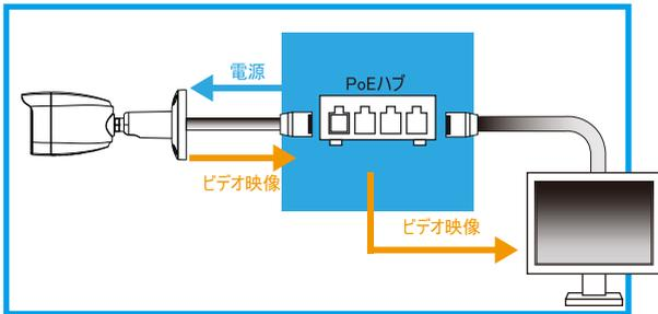
電源供給装置を利用すると、ネットワークケーブルのみで、データと電源を同時転送が可能です
