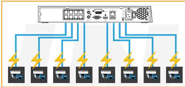
本体から直接カメラにネットワークケーブルを通じて電源を供給します。設置時の電源関連問題を最小化し、一目で動作の有無を確認することができシステムの安定的な運用を可能にします。
