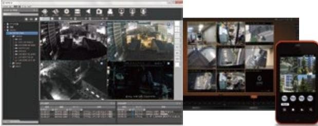
遠隔からネットワークでレコーダーに接続してライブ映像監視、録画データの検索再生、録画データバックアップが可能で、リアルタイムで装置の状態をチェックできます。。
