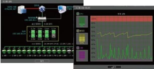
システムの状態、ネットワーク接続情報、接続されたクライアント数、カメラPOE状態確認可能。
